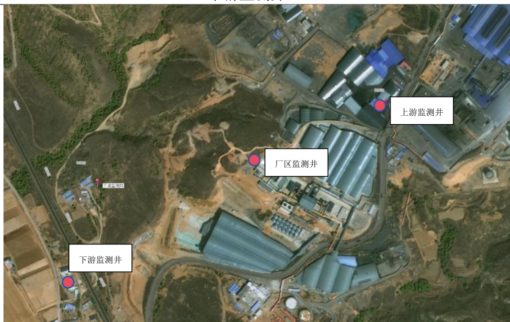
图 8.2-1 厂区地下水监测井实际分布图
