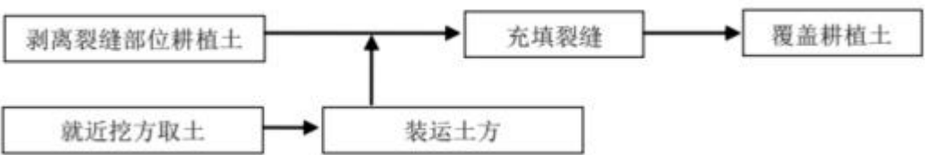
图 6.7-1 耕地整治工艺流程图
