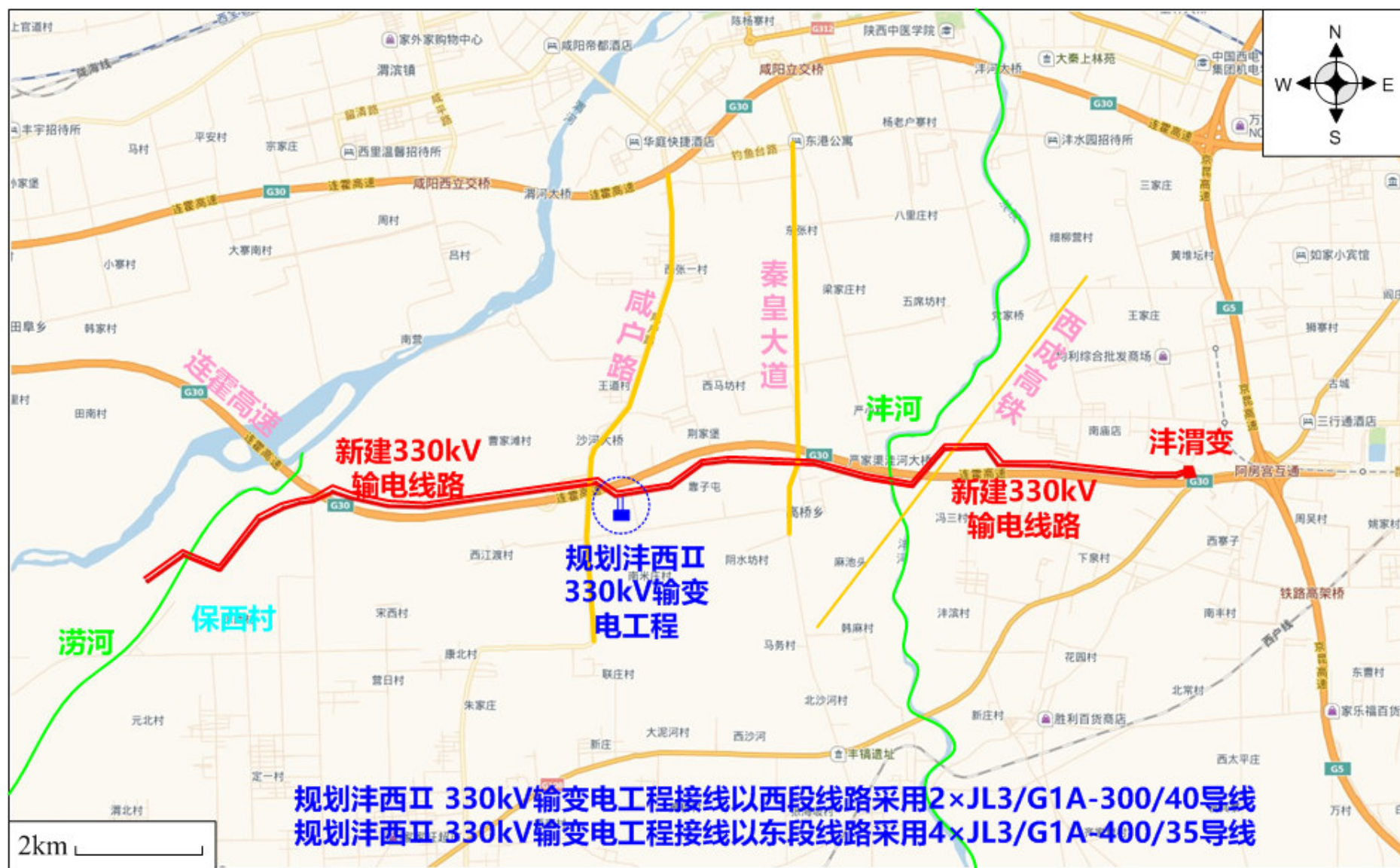
图 3.1-3 本项目输电线路路径示意图
