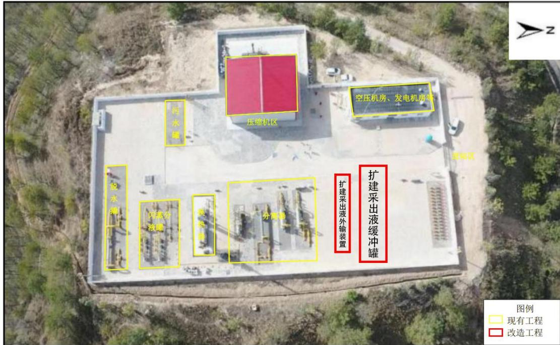
图 3.2.3.2 高 13 集气站改造平面布置
