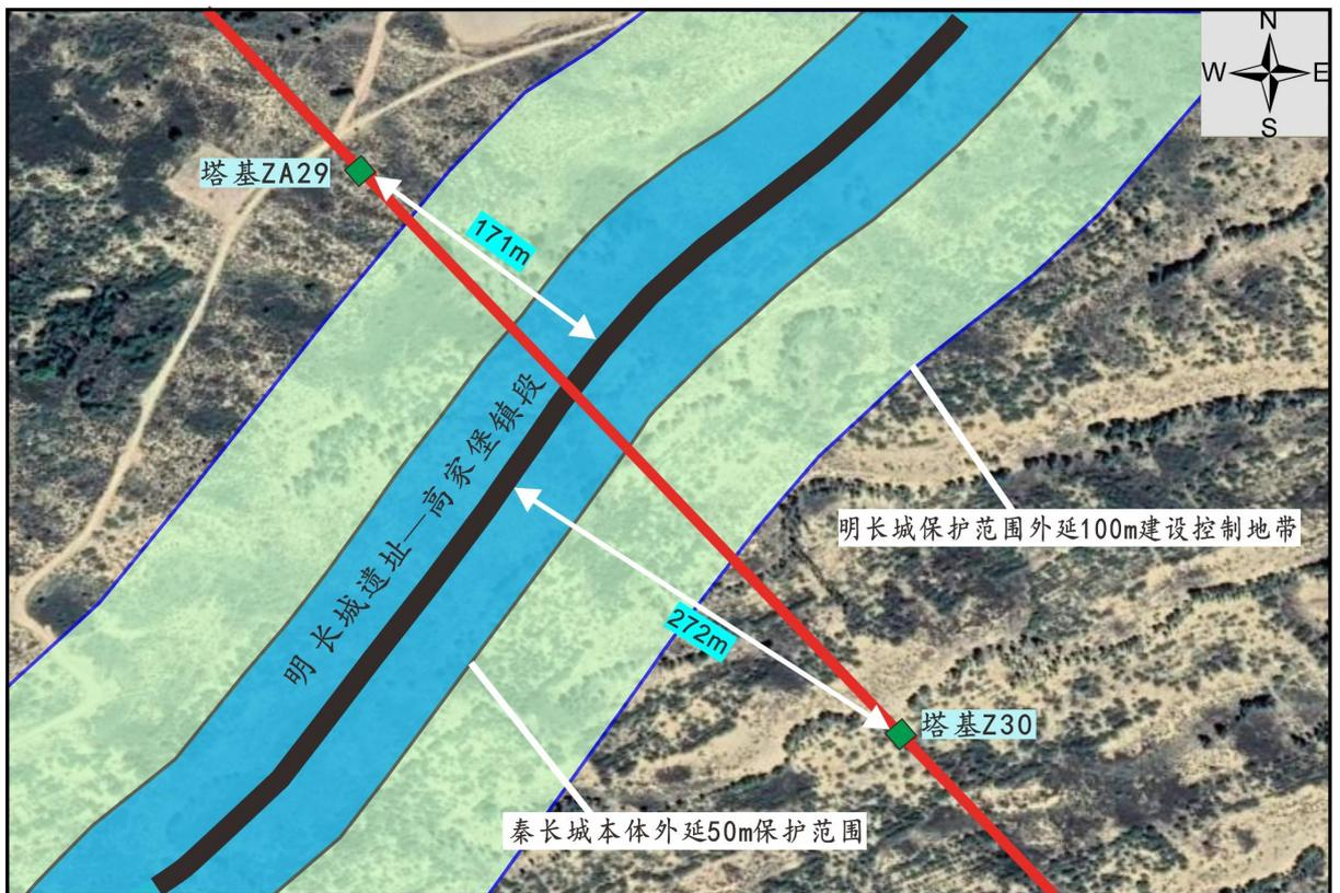
图 2.5-7 本工程线路与明长城遗址-高家堡镇段位置关系图
