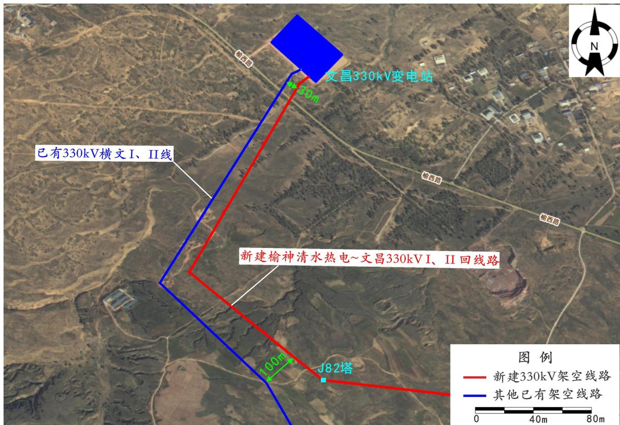
图 3.1-7 本工程线路与 330kV 横文 I、II 线平行段位置关系
