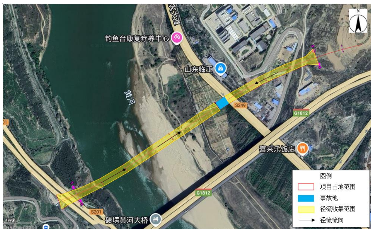
图 7.4-3 桥梁径流收集系统示意图
