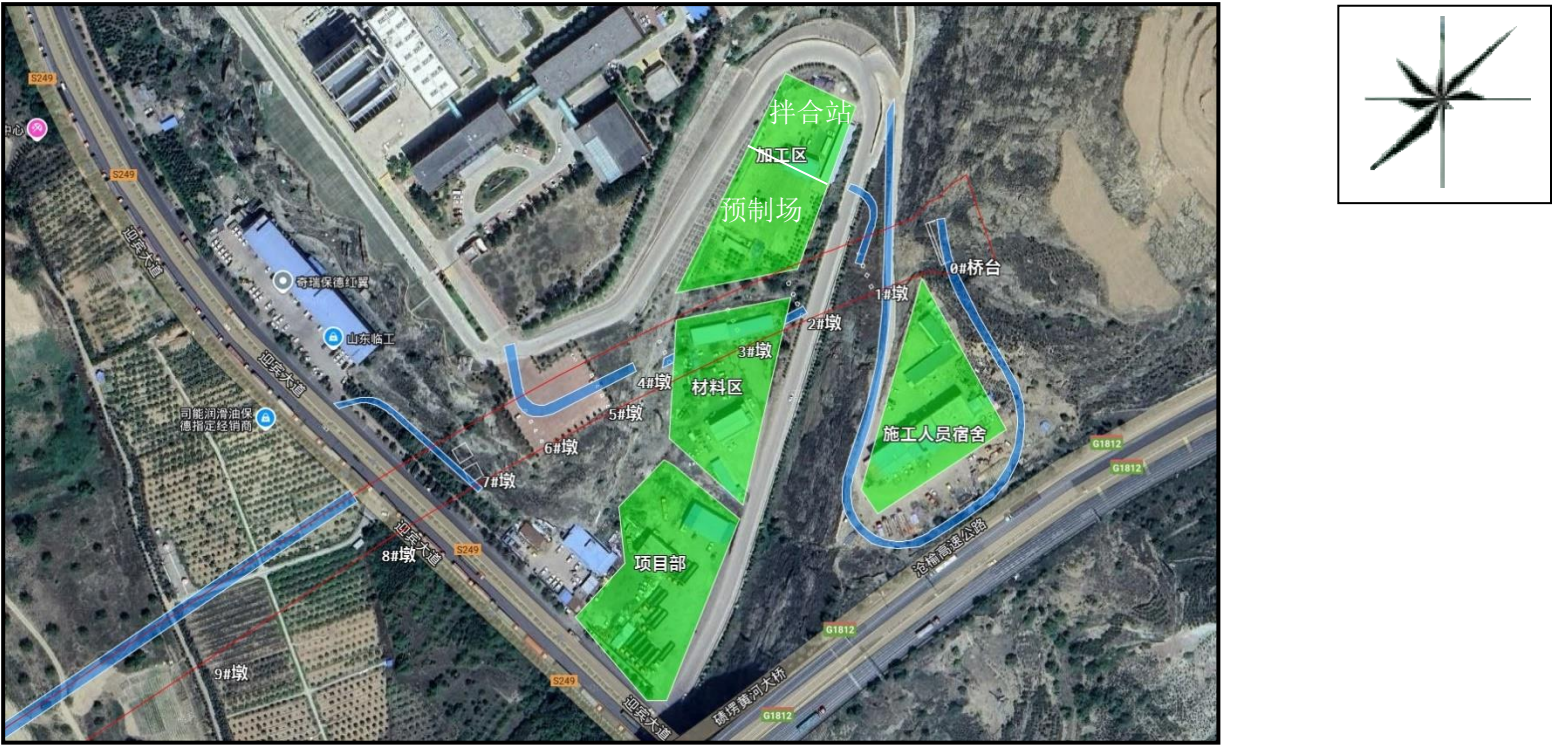
图 2.5-29 项目施工期临时工程布置图 1
