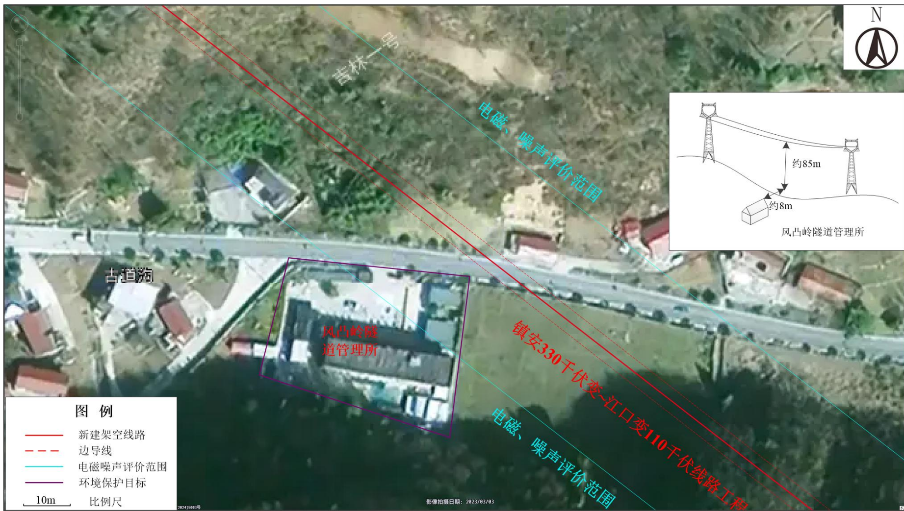
图 3-13.1.1 输电线路评价范围与环境保护目标（风凸岭隧道管理所）位置关系示意图
