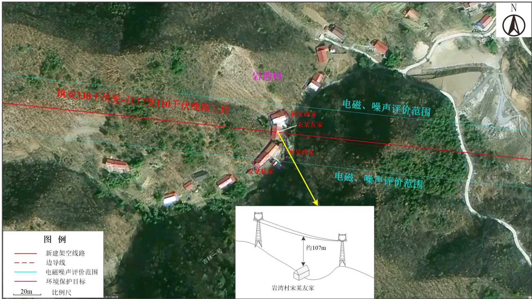
图 3-12.1.1 输电线路评价范围与环境保护目标（岩湾村局部）位置关系示意图
