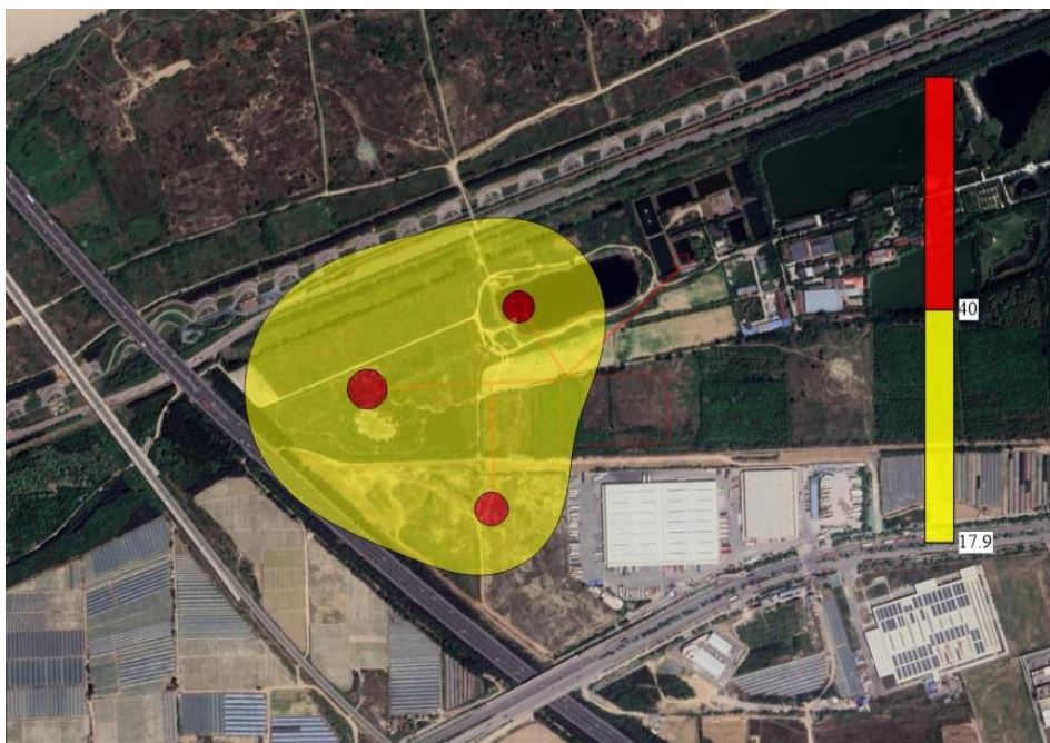
图 6.1-4 (c) 工作模式 2 电场强度预测结果等值线图 3 (单位: V/m)
