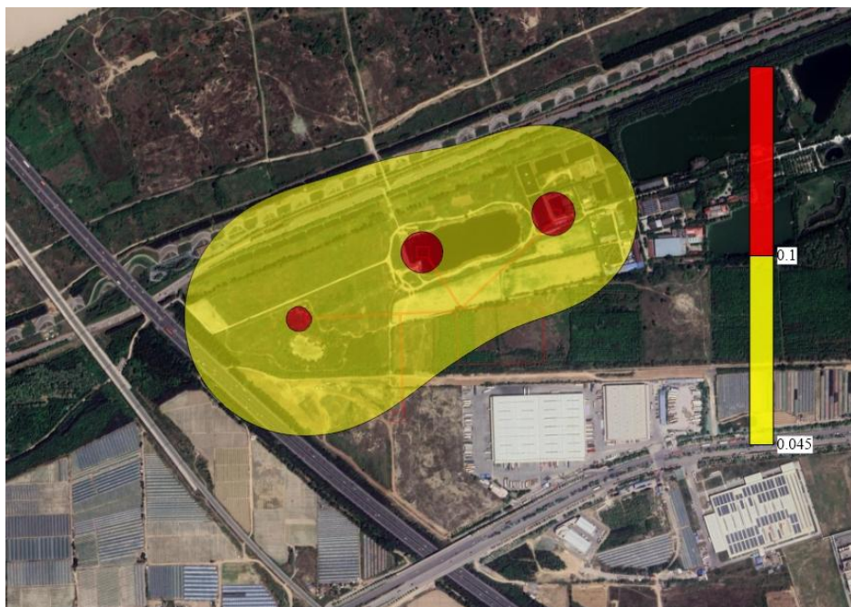
图 6.1-7 (c) 工作模式 3 磁场强度预测结果等值线图 3 (单位: A/m)
