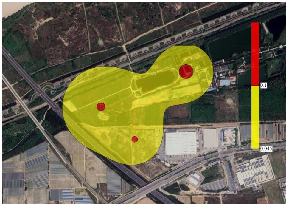
图 6.1-3 (c) 工作模式 1 磁场强度预测结果等值线图 3 (单位: A/m)
