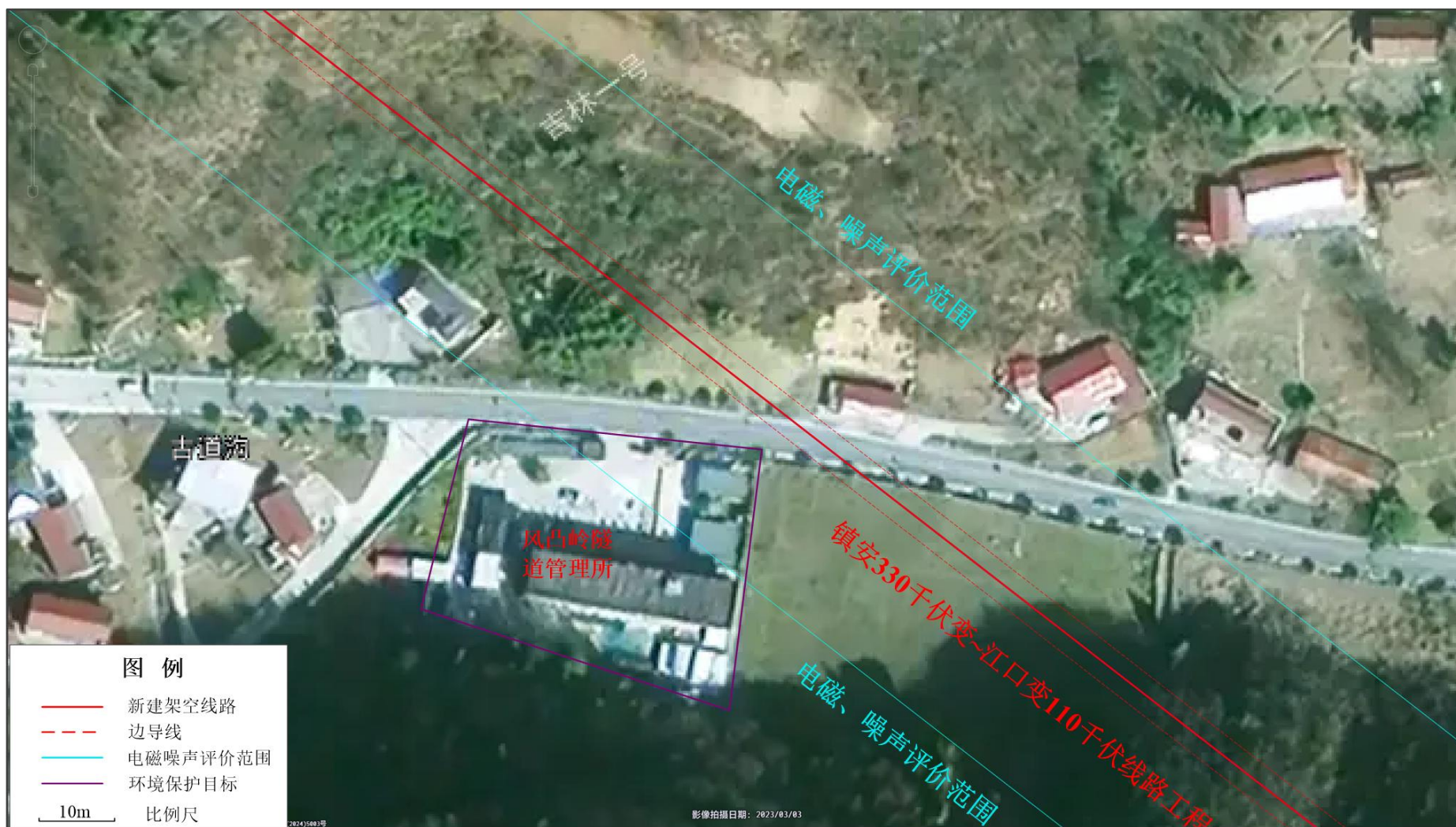
图 3-14.1 输电线路评价范围与环境保护目标（风凸岭隧道管理所）位置关系示意图
