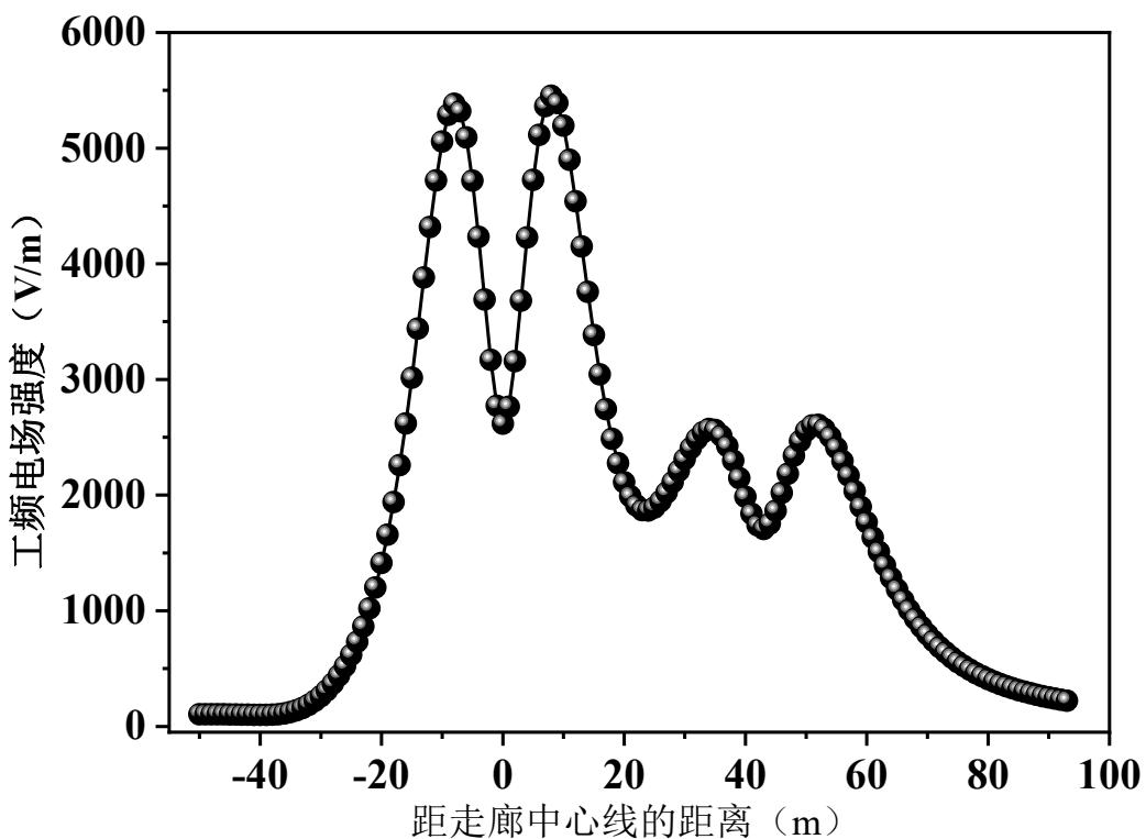
图 6.1.3-9 工频电场强度趋势图（330kV 双回 4 分裂架空线路与 330kV 单回双分裂架空线路并行）
