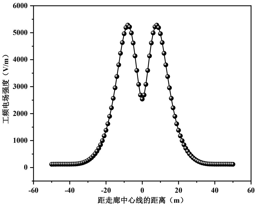
图 6.1.3-1 工频电场强度趋势图（330kV 双回 4 分裂架空线路）
