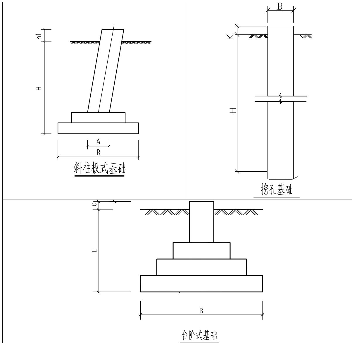
图3.1.1-5 本工程输电线路塔基基础型式图
