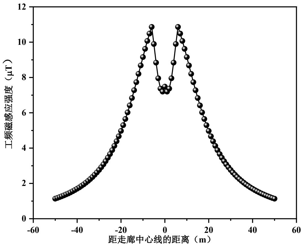
图 6.1.3-5 工频磁感应强度趋势图 (330kV 单回双分裂架空线路)
