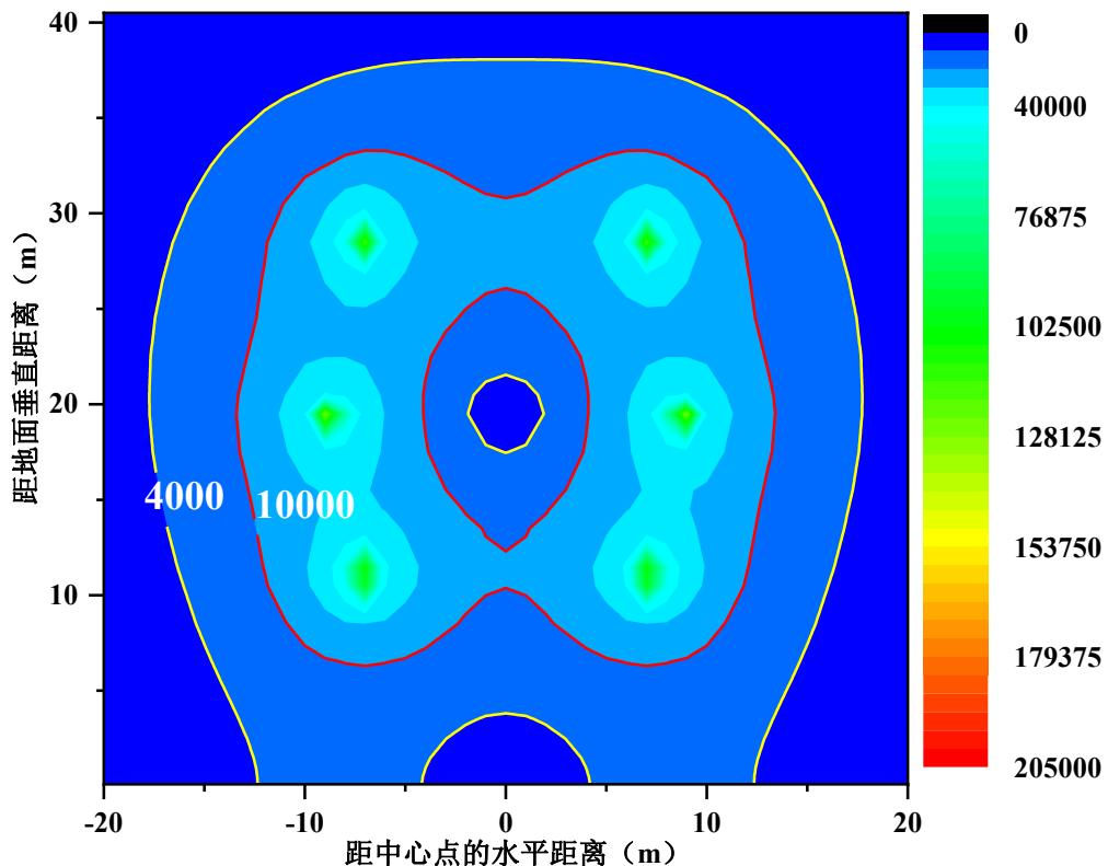
图 6.1.3-3 本工程 330kV 双回线路工频电场强度空间分布图
