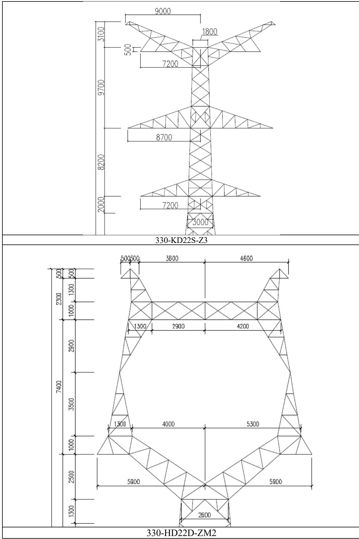
图 6.1.2-1 本工程电磁预测铁塔塔型示意图
