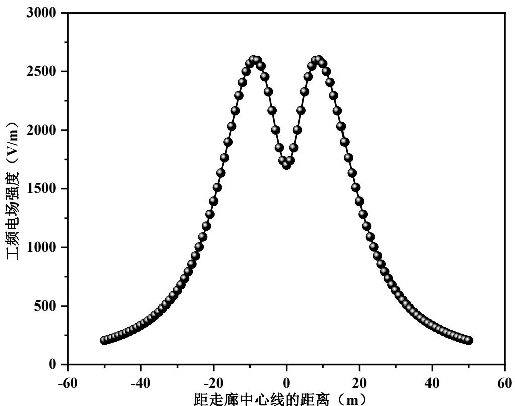
图 6.1.3-4 工频电场强度趋势图 (330kV 单回双分裂架空线路)
