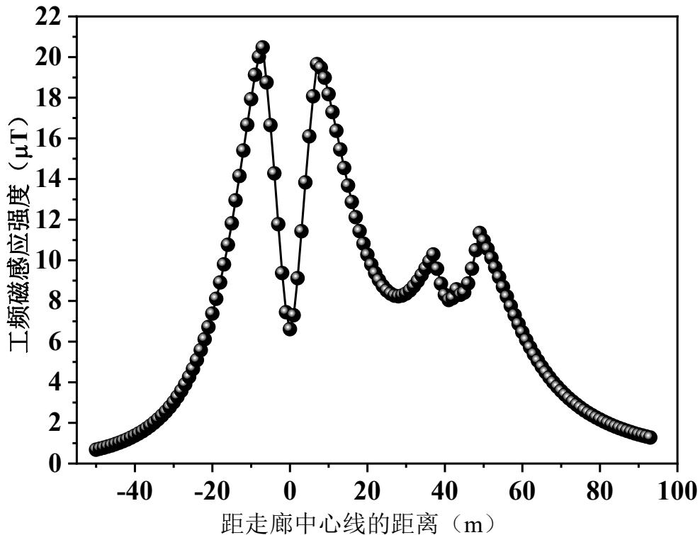
图 6.1.3-10 工频磁感应强度趋势图（330kV 双回 4 分裂架空线路与 330kV 单回双分裂架空线路并行）
