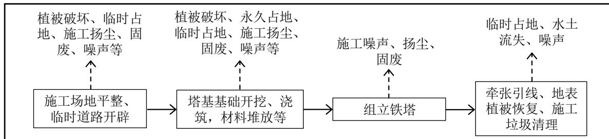
图 3.3.1-1 工程施工期工艺流程及产污环节示意图
