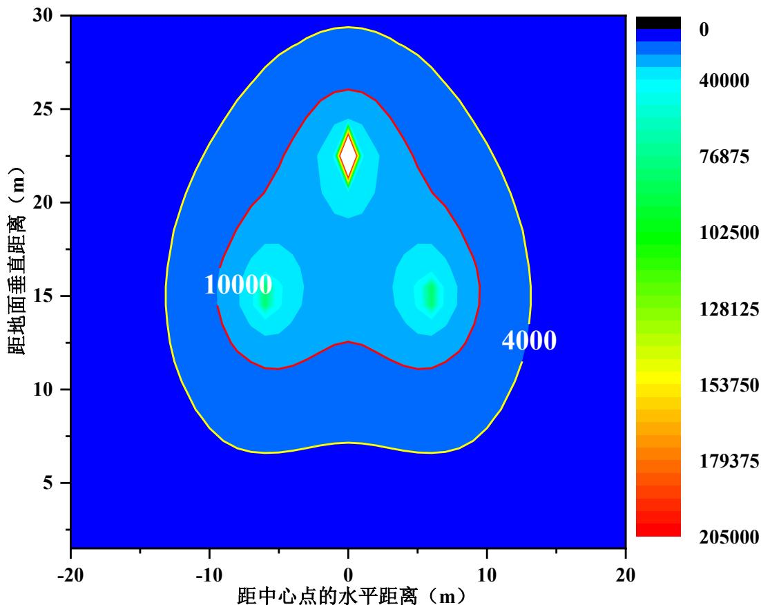
图 6.1.3-6 本工程 330kV 单回线路工频电场强度空间分布图
