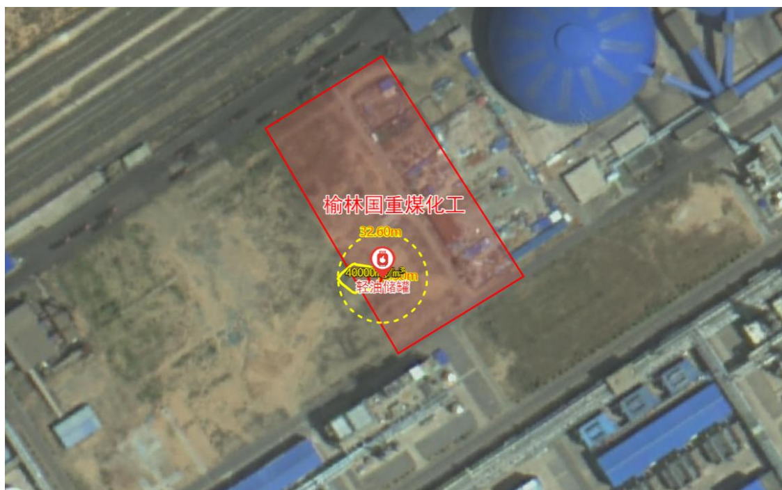
图 6.6-2 轻油储罐泄漏预测结果图
