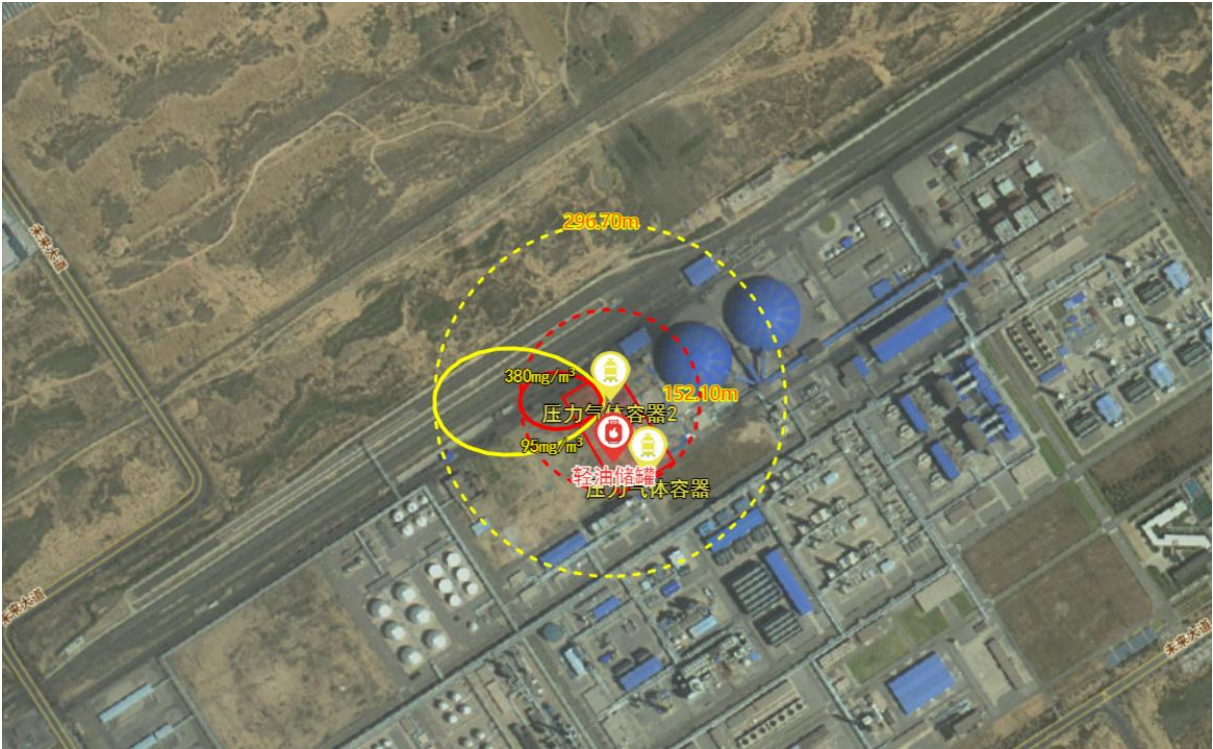
图 6.6-1 尾气 MDEA 脱碳中试装置合成气尾气 CO 泄漏预测结果图
