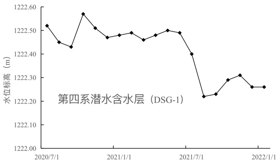
图 6.6.2-1 袁大滩第四系潜水含水层水位变化图
