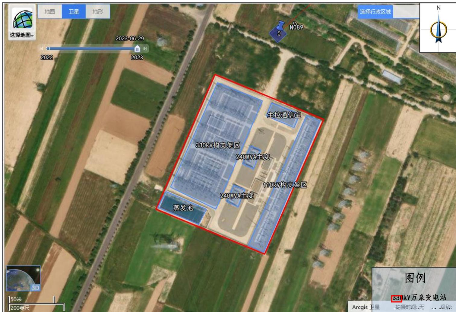
图3.1-6 万泉330kV变电站平面布置图
