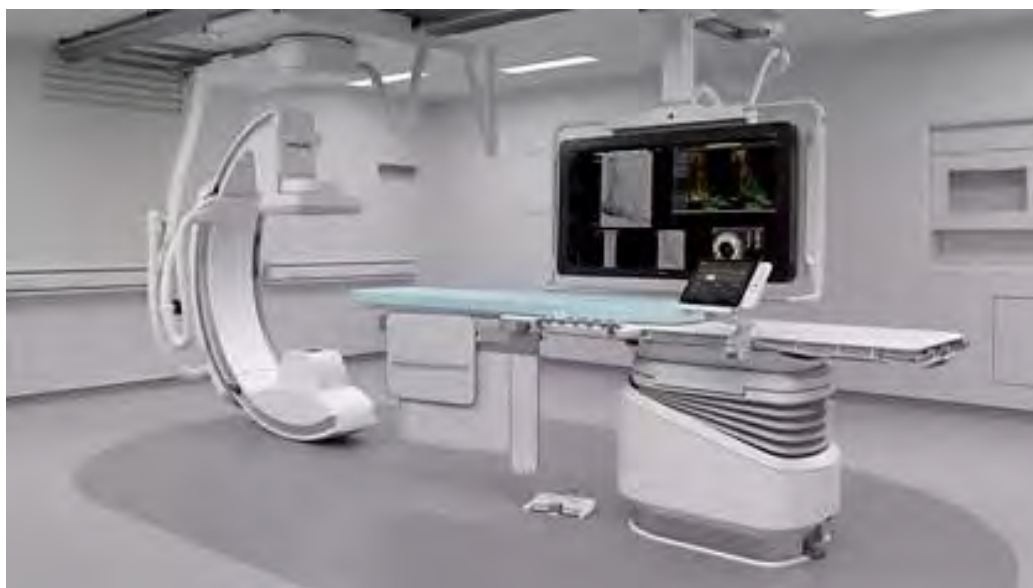
图 9-13 医用血管造影 X 射线系统（DSA）
