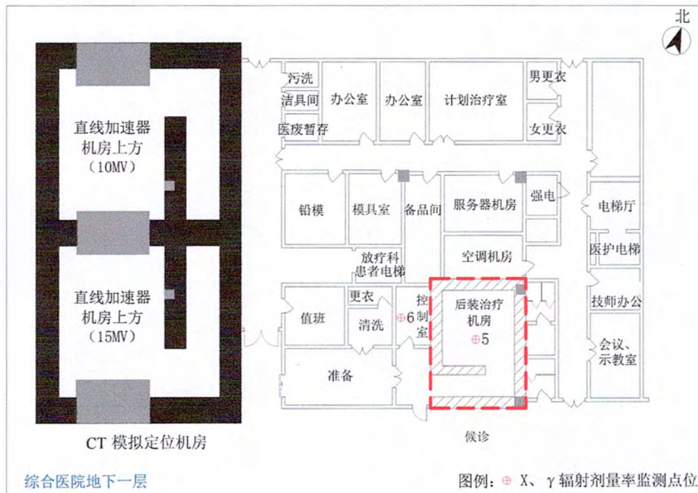
图 3-2 拟建后装治疗机房 X、γ 辐射剂量率监测点位示意图
