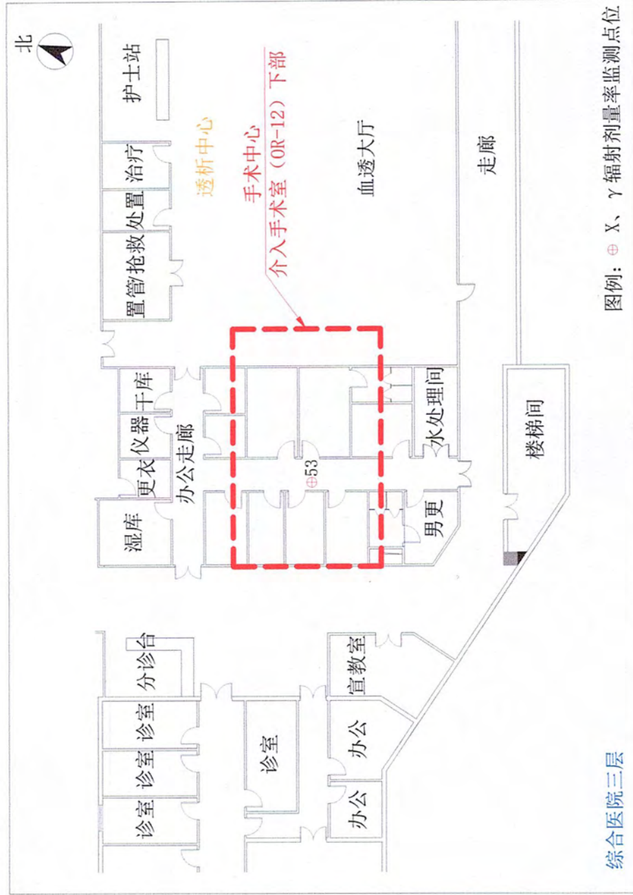
图 3-9 综合医院手术中心拟建介入手术室 (OR-12) 下部 X、γ 辐射剂量率监测点位示意图
