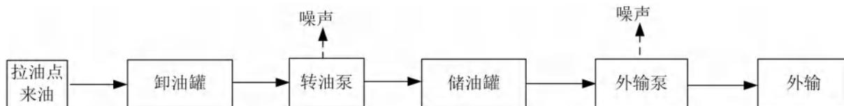
图 3.2-9 刘峁塬卸油台工艺流程及产污环节图
