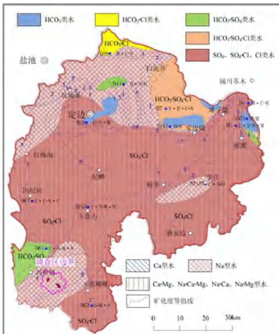
图 4.1-9 定边区域白垩系地下水水化学类型分区图
