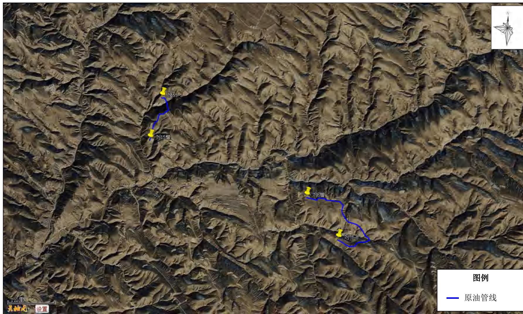
图2.5-3 项目定边区域管线走向图
