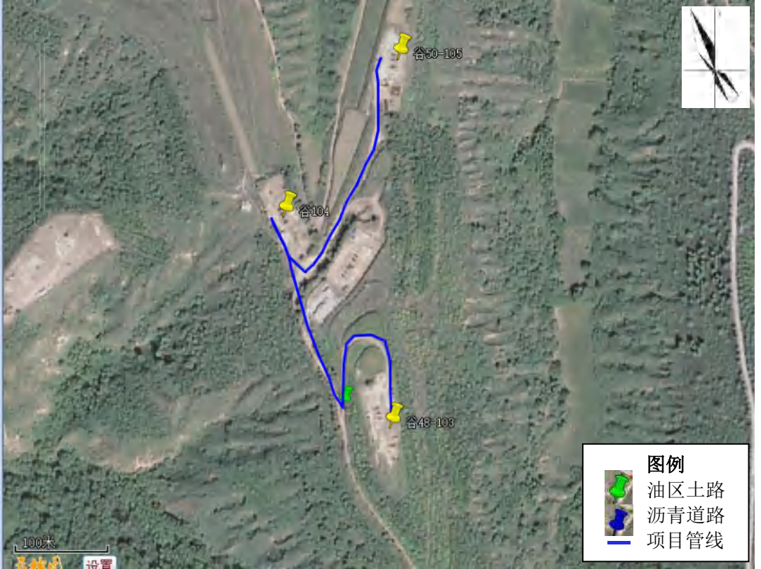
附图 2.5-5 管线穿越道路示意图（2）
