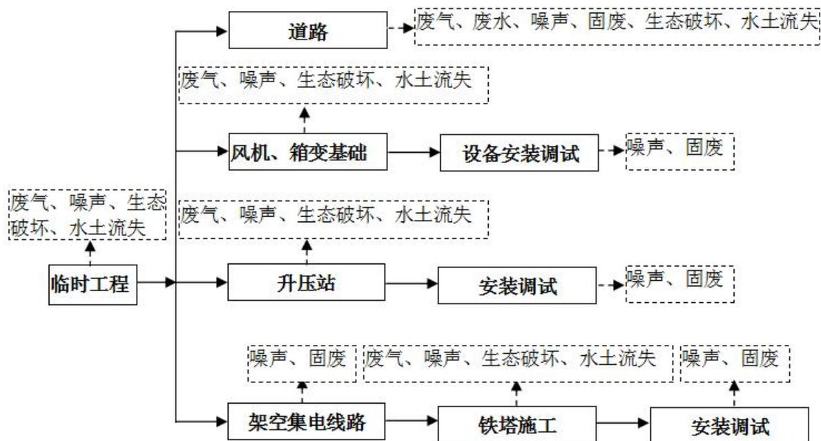
图 4-1 项目施工期污染环节示意图
