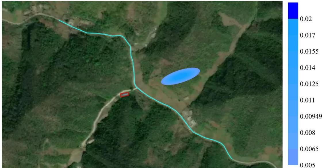
图 6.3-2 沉淀池发生非正常泄露 365d 后氨氮浓度分布图
