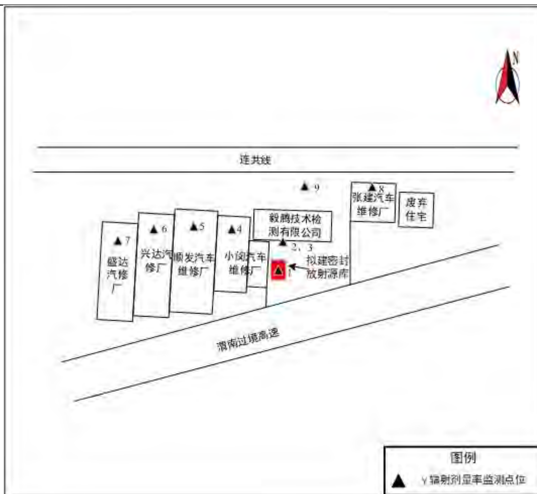
图 8-1 拟建密封放射源库及其周边区域 \gamma 辐射剂量率监测点位示意图
