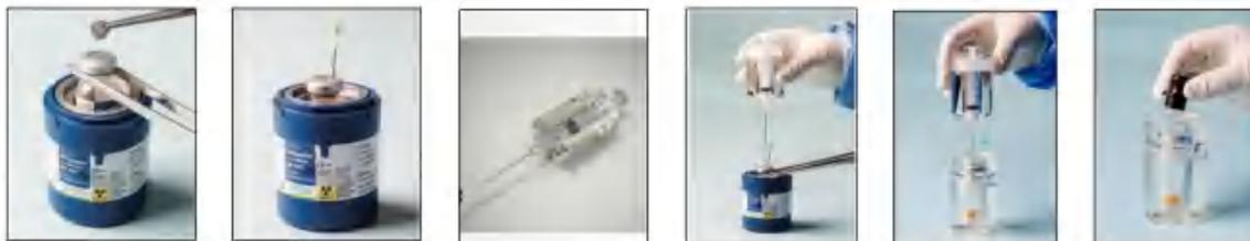
图 9-11  $^{90}\text{Y}$  树脂微球总活度测量和抽取示意图
