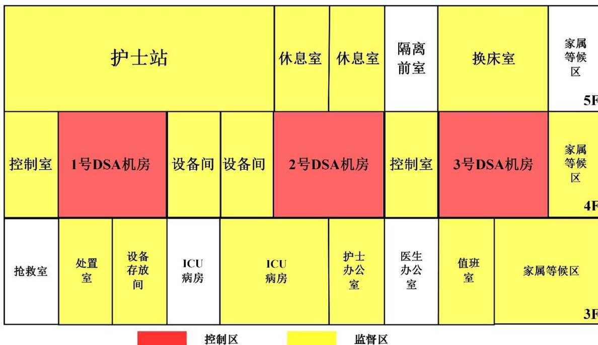
图 10-7 介入科 DSA 机房工作场所划分示意图（剖面）
