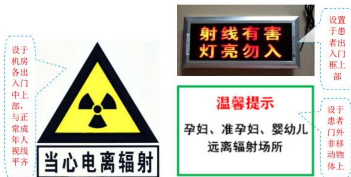
图 10-3 警示设施样例图
