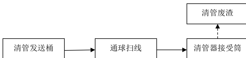
图 3.2-6 清管工艺流程及产污环节图
